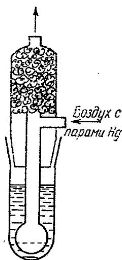
Рисунок 1.21 - Схема аэратора - барботера
