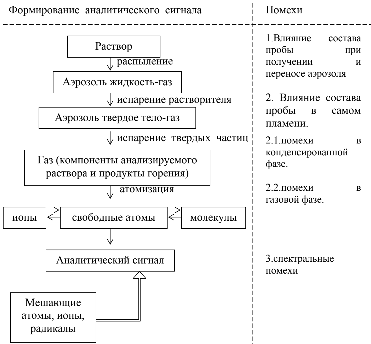
Рисунок 4.1 - Процессы, определяющие формирование аналитического сигнала в пламени и классификация помех
