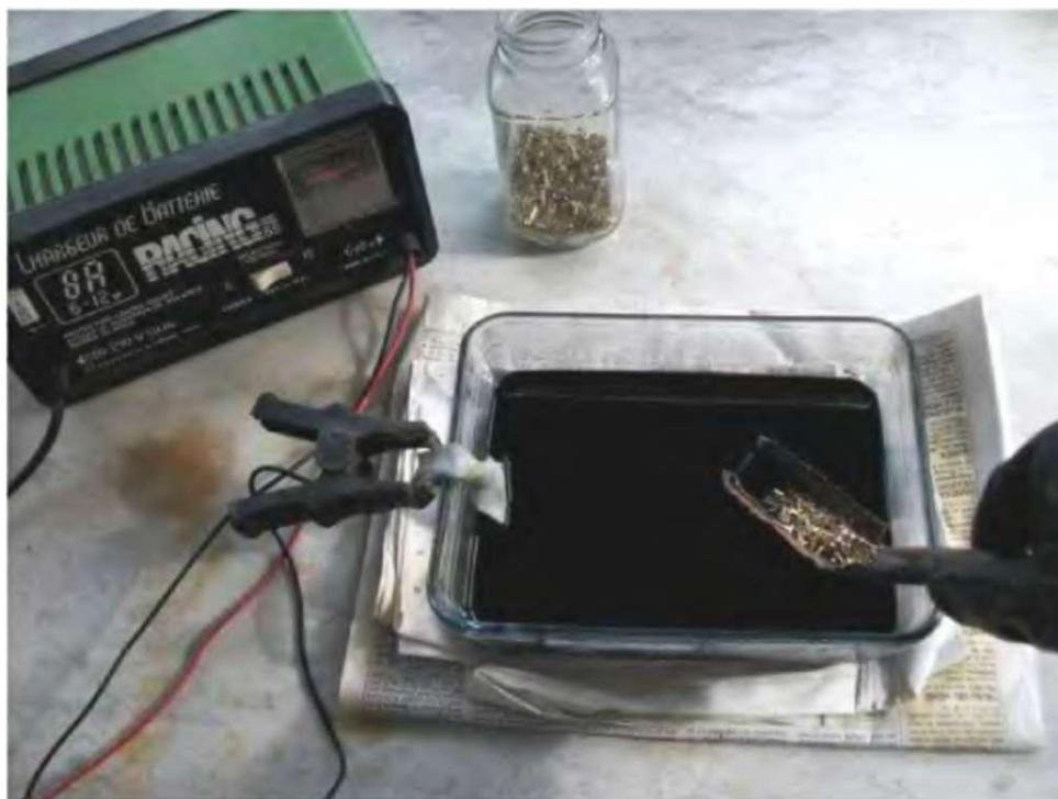
Когда мы пропускаем через ячейку электрический ток (мы использовали обычное зарядное устройство для аккумуляторов) медь на аноде (и на контактах) растворяется и осаждается на катоде из свинца. Золото, уже не связанное с медью, формирует осадок на дне ячейки. Также следует отметить, что во время этого процесса температура в ванне значительно повышается.
