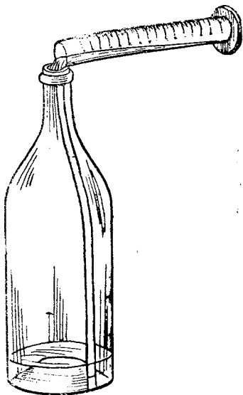
Рис. 34. Изготовление спирометра из бутылки.
