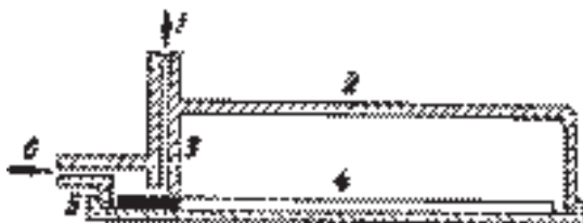
Рис. 1.48. Устройство для отбора проб [286]: 1 — входное отверстие для исследуемого воздуха; 2 — камера; 3 — перегородка, препятствующая попаданию исследуемого воздуха на часть пластинки, предназначенной для разделения сконцентрированных примесей; 4 — пластинка для ТСХ (черным слоем обозначена часть пластинки с сорбентом для концентрирования примесей); 5 — основание камеры; 6 — выходное отверстие для воздуха после контакта с сорбентом.
