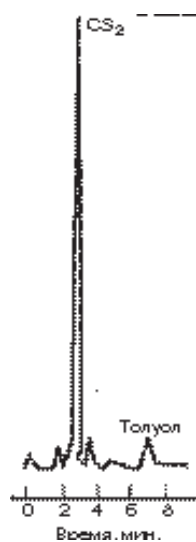
Рис. 1.38. Хроматограмма воздуха, загрязненного сероуглеродом в производстве вискозы [240], полученная на капиллярной колонке с химически связанным силиконом OV — 1701 (толщина пленки 0,1 мкм) при 85°C с ЭЗД.
