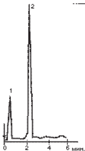
Рис. I.46. Определение формальдегида в воздухе в виде производного с уротропином [99]. Условия в тексте. 1 — растворитель; 2 — гексаметилентетрамин.
