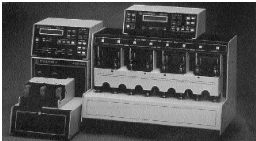
Рис. III.3. Автоматический термодесорбер для анализа газовой выделения почвы методом газовой хроматографии [21]. Пояснения в тексте.
