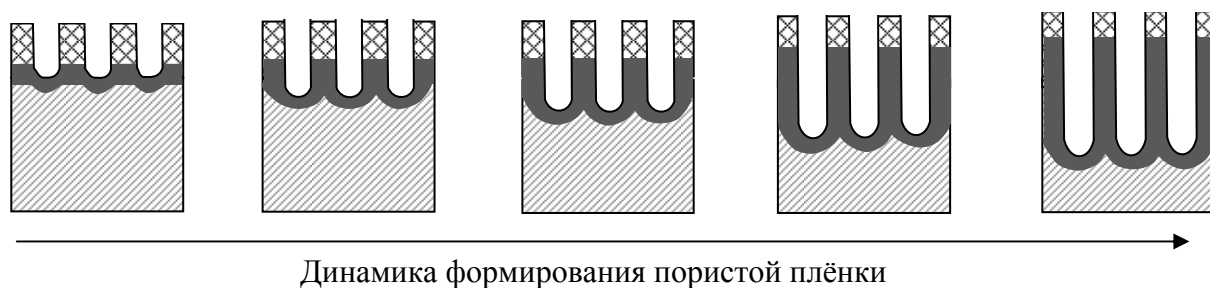
Рис. 3.2. Этапы формирования упорядоченной ячеистой структуры пористой части оксидной плёнки: – естественная оксидная плёнка, – анодная оксидная плёнка, – алюминий
