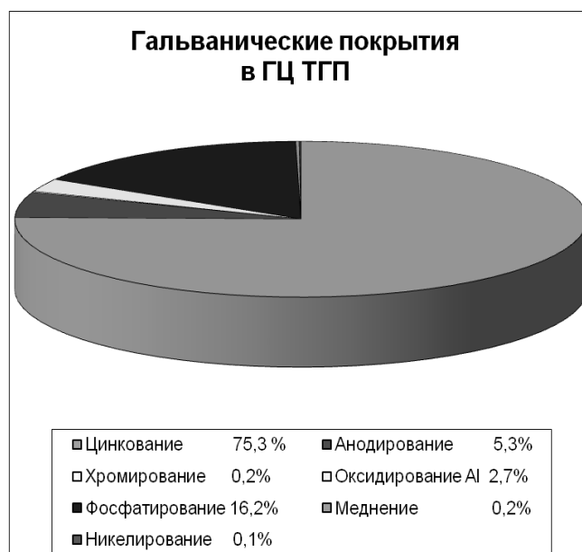
Рисунок 1 - Структура удельных объемов обработки по видам гальванических покрытий изделий в гальваническом цехе Минского автомобильного завода
