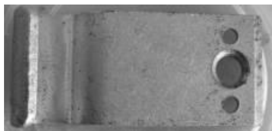
Рисунок 3 - Внешний вид детали «запор» после проведения испытаний в течении 100 ч
