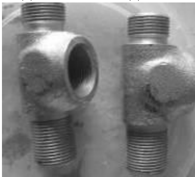
Рисунок 2 - Внешний вид детали «крестовина» после проведения испытаний в течении 24 ч
