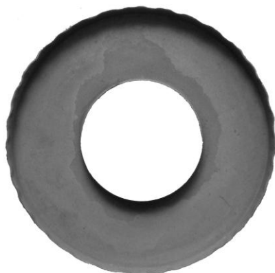
Рисунок 2 – Пятнистость на детали подвергнутой диффузионному цинкованию без предварительной очистки тонкого видимого слоя смазки после механической обработки
