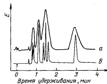
Рис. 2.3.4/3. Зависимость качества разделения от размеров частиц сорбента при высокой линейной скорости потока элюента (Merck, Darmstadt):
