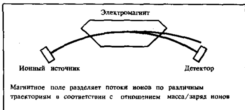
Рис. 6. Принципиальная схема масс-спектрометра.
