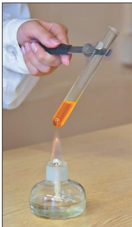
*Рис. 14. Нагревание жидкости в пробирке на открытом пламени*
