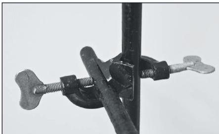
Рис. 8. Закрепление муфты на стержне штатива и лапки в муфте
