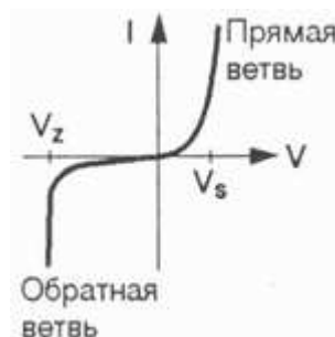
Рис. 2.15. Вольт-амперная характеристика стабилитрона.
