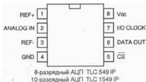
Рис. 2.4. Расположение выводов аналого-цифрового преобразователя TLC 549
