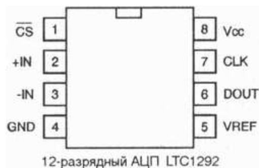
Рис. 2.13. Расположение выводов АЦП LTC 1292.
