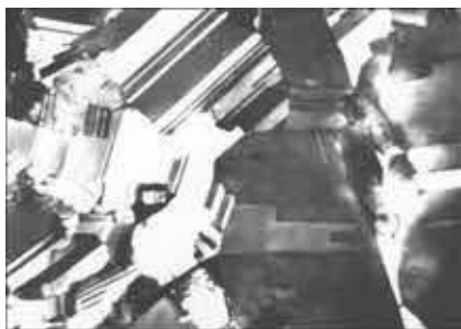
Рис. 14.2. Двойниковые границы легко наблюдаются методом просвечивающей электронной микроскопии благодаря специфическому полосчатому контрасту; показан осадок меди из пиррофосфатного раствора, размер области 4 \times 6 мкм
