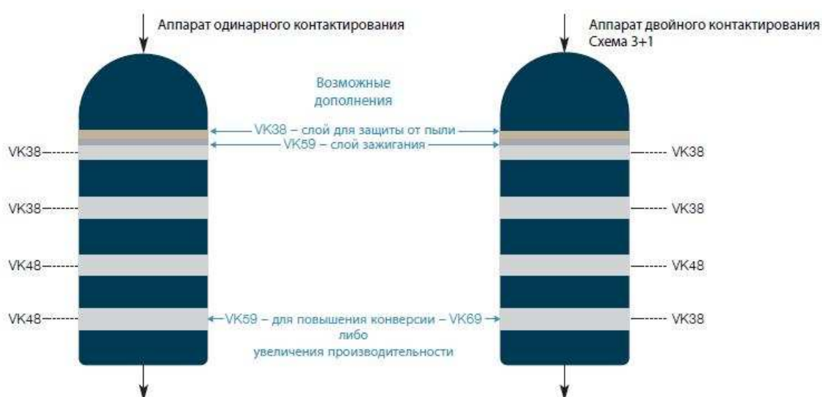
Рис. 2.19. Загрузка катализатора в контактный аппарат.
