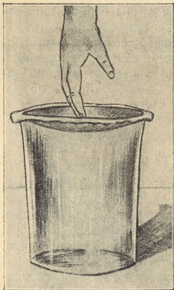
Рис. 6. Простейший диализатор.
