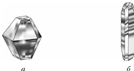
Рис. 41. Формы и строение кристаллов серы: а — ромбической; б — моноклиной
