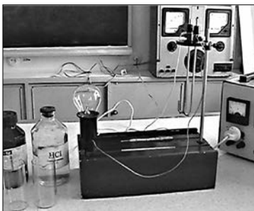
Рис. 27. Прибор для испытания электропроводности растворов
