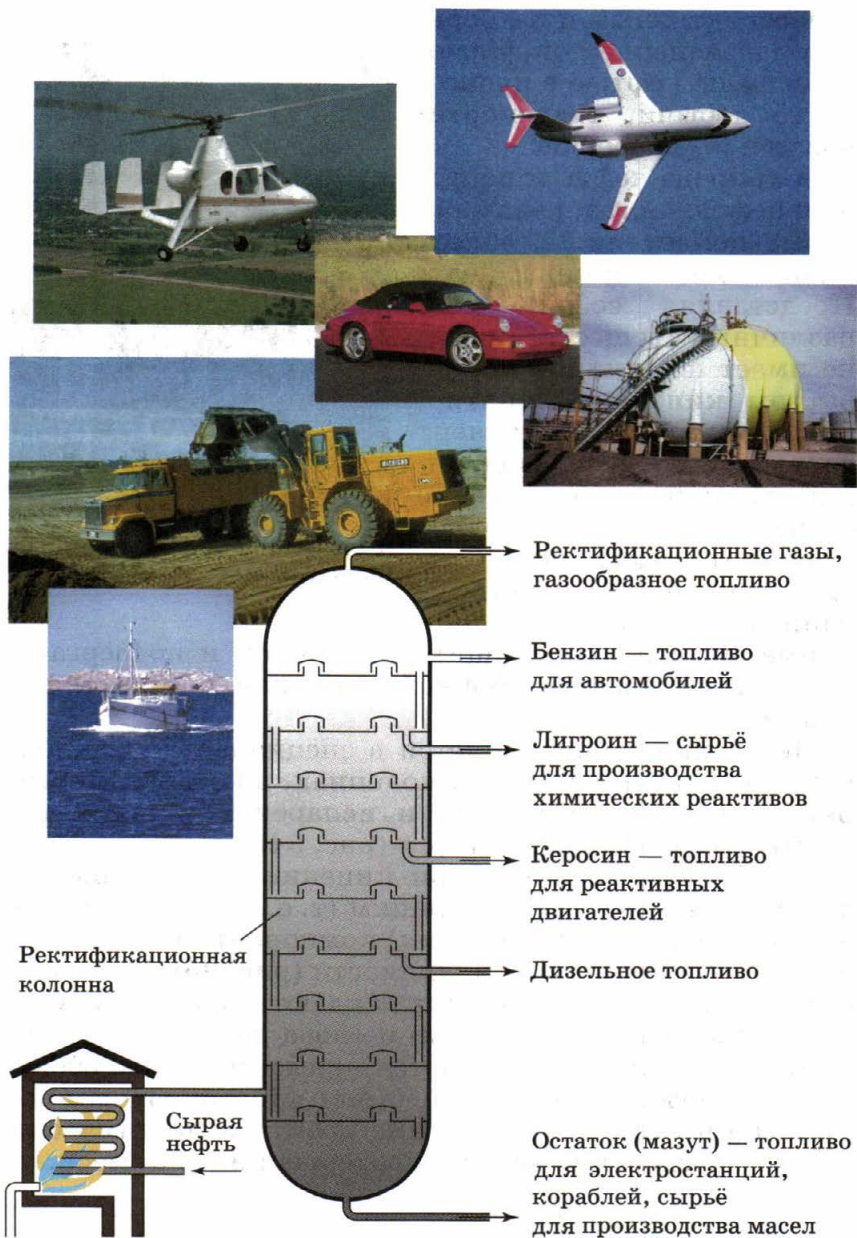
Рис. 35. Схема установки (ректификационной колонны) для непрерывной перегонки нефти и области применения нефтепродуктов
