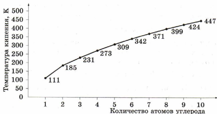
Рис. 10. Зависимость температуры кипения алканов нормального строения от числа углеродных атомов в молекуле
