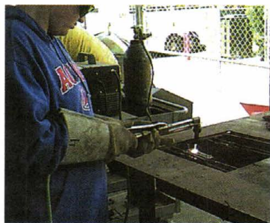
Рис. 23. Пламя ацетиленовой горелки используют для резки и сварки металлов
