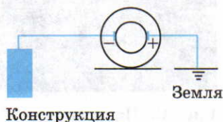
Рис. 45. Схема катодной защиты
