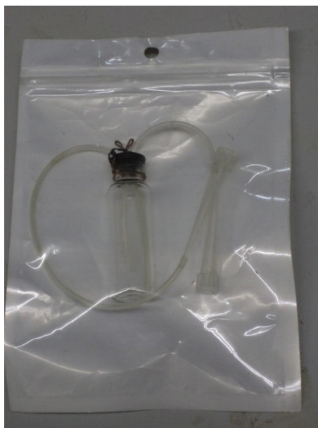
Проточная кювета для хроматографии
