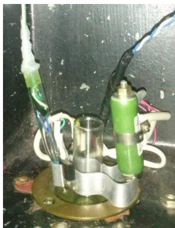
Самодельный электротермостатируемый кюветодержатель.
