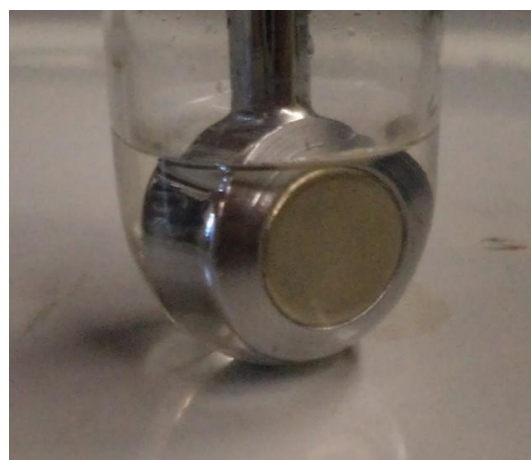
Головка излучателя, погруженная в жидкость (крупный план)
