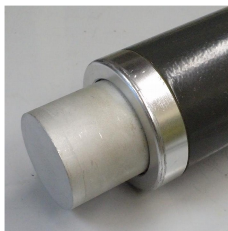
Сцинтиллятор (головка зонда) (крупным планом)
