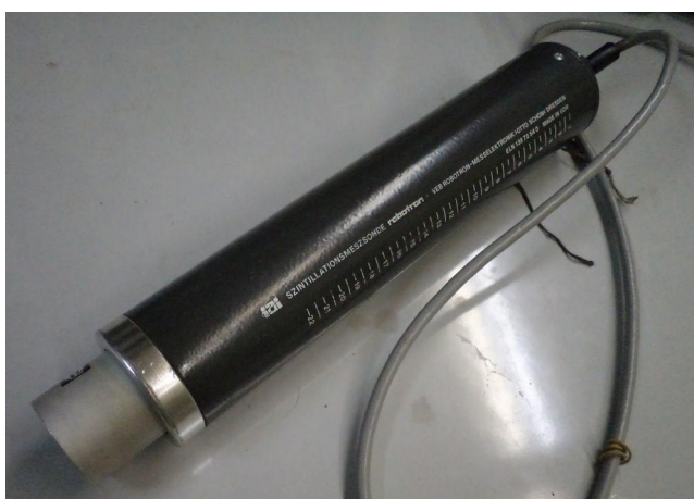
Сцинтилляционный зонд (общий вид)
