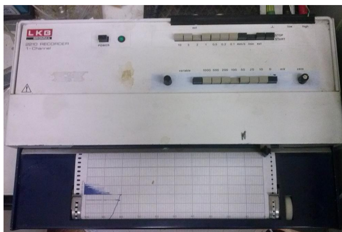
Самописец LKB 2210 размах шкалы — от 10 мВ до 1 В типичный представитель эпохи конца 80-х — начала 90-х
