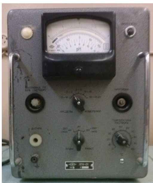
Лабораторный потенциометр универсальный ЛПУ-1 ( рН-метр — милливольтметр )
