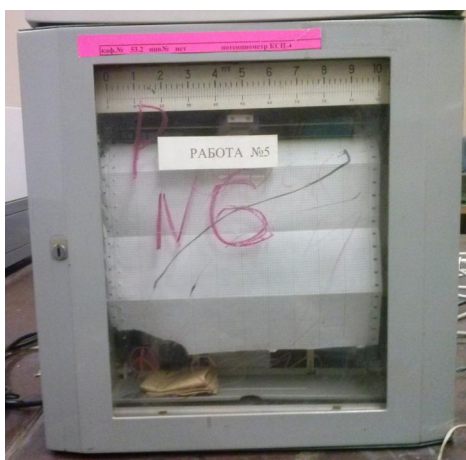
Самописец КСП-4 размах шкалы — 10 мВ был весьма распространён в СССР
