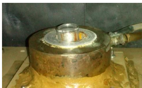
Термостатируемые водой медные кюветодержатели
