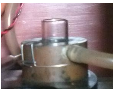
Термостатируемые водой медные кюветодержатели
