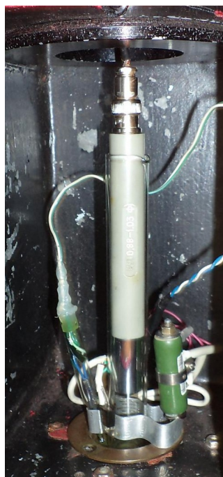
Система пробирки с излучателем установленная в хемилюминесцентр
