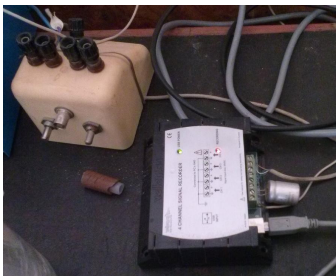
Четырёхканальный лабораторный АЦП (справа) и мост сопротивлений термодатчика (слева)
