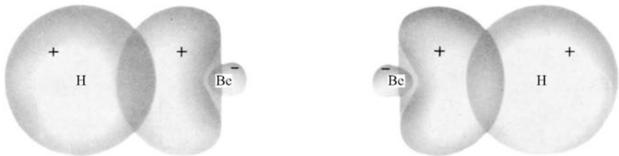
Fig. 127 Zustandekommen der beiden bindenden lokalisierten Molekülorbitale des linear gebauten Berylliumdihydrids durch Überlappung der beiden sp-Hybridorbitale des Be mit jeweils einem 1s-Wasserstoffatomorbital.
