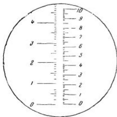
Рис. 60. Определение цены деления окулярного микрометра.
