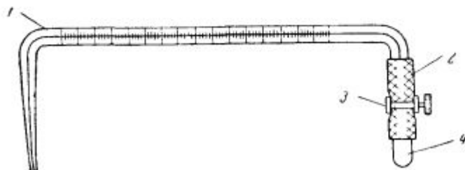
Рис. 89. Ультрамикробюретка с пневматическим микрорегулятором:
