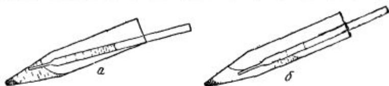
Рис. 47. Удаление жидкости над осадком с помощью капилляра: а—правильное положение капилляра; б—неправильное положение капилляра.
