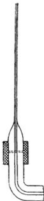
Рис. 92. Капилляр для торможения вытекания раствора, присоединенный к гидростатической ультрамикробюретке.
