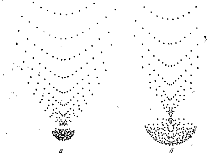
Рис 17. Характер распределения освещенности в пятне рассеивания в зависимости от плоскости установки при наличии аберрации кома a — плоскость проходит через точку M'_1 (см рис. 10); b — плоскость проходит через точку M'_2
