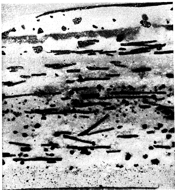
Рис. 22. Электронно-микроскопический снимок вертикального среза цветной фотопленки «Кодаколор» VR-1000
