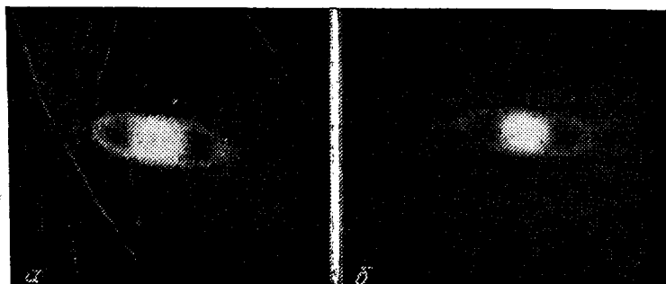
Рис. 68. Сатурн в 1976 г. 150-миллиметровый рефлектор, окулярная камера, A_{\text{экв}} = 1/30 . Пленка «Микрат-300», выдержка 6 с. Отпечаток а получен с одного негатива, б — с пяти. Обратите внимание на дефекты негатива, исчезнувшие на снимке б . Фото Л. Л. Сикорука
