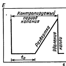
РИС. 5.3. Последовательность операций при регистрации вольтамперограммы с линейной разверткой потенциала с КРЭ с регулируемым периодом капания [Anal. Chem., 46, 1934 (1974)].
