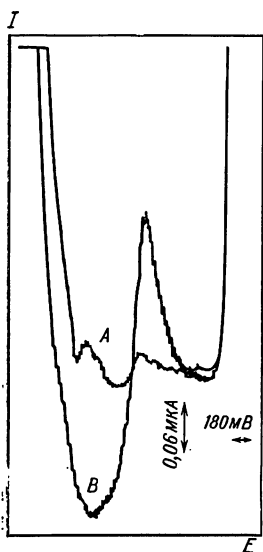
РИС. 7.45. Переменноточковые полярограммы для А — 0; В — 5 \cdot 10^{-5} М бутакарба в 10%-ном метаноле при \text{pH}=8,98 (0,2 М борная кислота + 0,2 М гидроксид натрия) [79].
