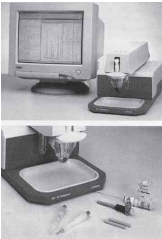
Рис. 3.9. Общий вид полярографа VA Computrace, управляемого персональным компьютером, и части его измерительного стенда, включая хлоридсеребряный электрод сравнения, платиновый вспомогательный электрод, вращающийся дисковый электрод и многоцелевой электрод (Metrohm AG)
