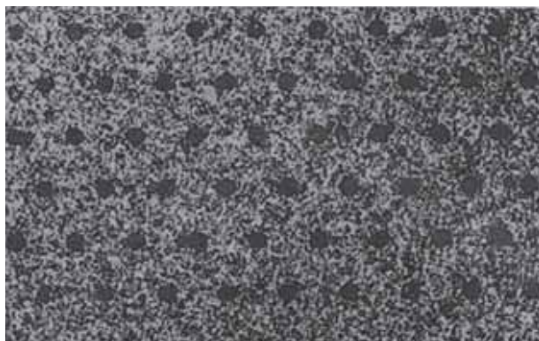
Рис. 3.20. Микрофотография поверхности массива микроэлектродов одноразового использования производства фирмы Ecossensor. Диаметр отдельных электродов 40 мкм. \times 100
