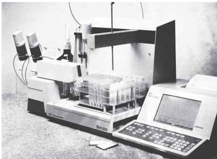
Рис. 3.30. Устройство для смены растворов VA-Autosampler 695 в сочетании с дозатором Dosino и измерительными блоками 746 VA Trace Analyzer и VA Stand 747 фирмы Metrohm AG
