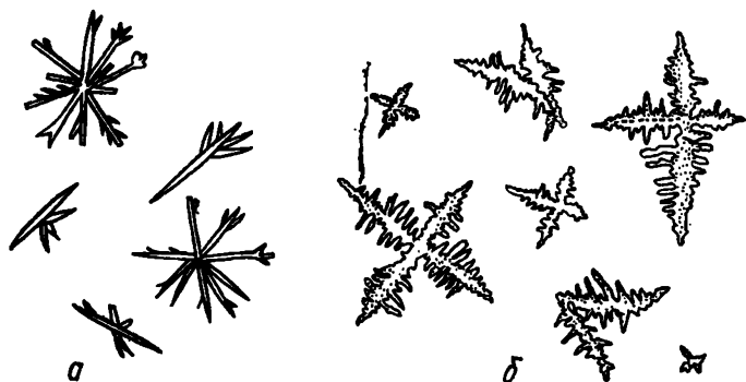
Рис. 2.11. Кристаллы \text{CuHg}(\text{SCN})_4 (а), \text{CuHg}(\text{SCN})_4 и \text{ZnHg}(\text{SCN})_4 изоморфные кристаллы (б)
