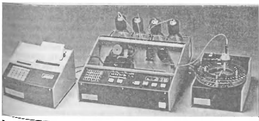
Рис. 6.2. Один из первых серийных проточно-инжекционных анализаторов (фирма «Tecator», Швеция)
