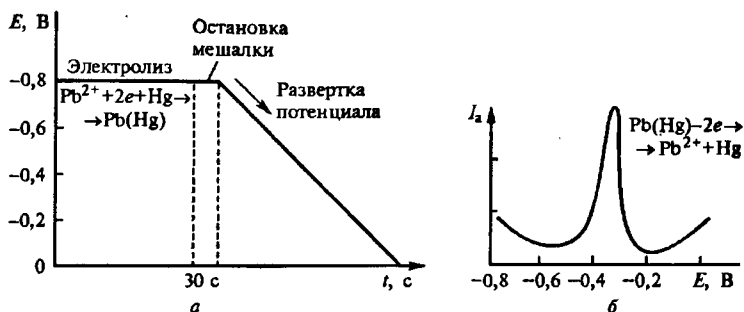
Рис. 10.49. Предварительный электролиз и развертка потенциала (а) и изменение тока (б) при регистрации анодной инверсионной вольтамперограммы на стационарном ртутном электроде
