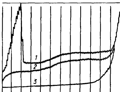
Рис. 10.36. Максимум I рода на полярограмме кислорода: 1 — на фоне 0,05 М раствора хлорида калия; 2 — та же полярограмма после добавления желатины; 3 — полярограмма 0,05 М раствора хлорида калия после удаления растворенного кислорода
