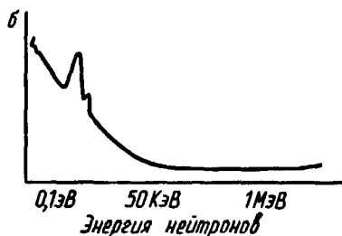
Рис. 13.1. Зависимость эффективного сечения захвата ядерной реакции \sigma от энергии нейтронов
