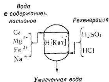
Рис. IV.32. Схема работы Н-катионитового фильтра.
