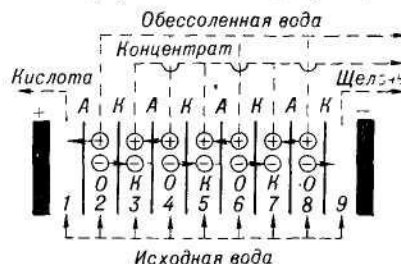
Рис. IV.41. Схема многокамерного электролизатора с катионо (К)- и анионо (А) обменными мембранами.
