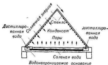
Рис. IV.36. Схема солнечного опреснителя типа «горячий ящик».
