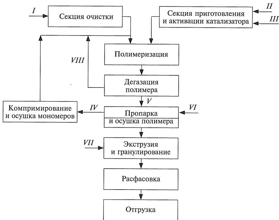
Рис. 6.18. Принципиальная блок-схема технологии производства полиэтилена:
