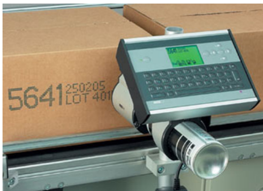
Рис. 2.33. DOD-принтер служит для нанесения простейших символов на транспортную упаковку
