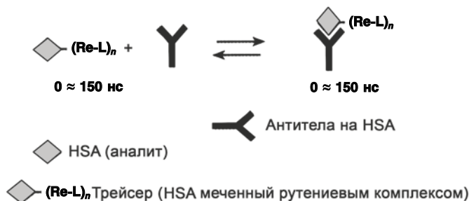
Рис. 8.18. Принцип поляризационного флуоресцентного иммуноанализа (FPIA). Корреляционное время вращения \theta различается для свободной (\text{Re-L})_n\text{-HSA} и связанной антителами фракции трейсера (\text{Re-L})_n\text{-HSA-анти-HSA}
