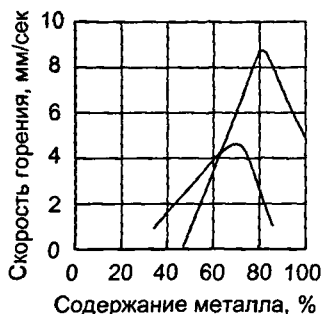
Рис. 6.2. Зависимость скоростей горения смесей разных металлов с нитратом калия от содержания металла в смеси [6].
