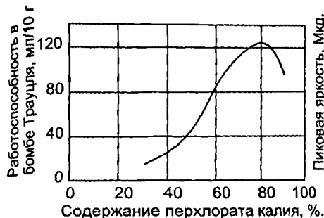
Рис. 20.5. Работоспособность двойных смесей ПХК/алюминий в зависимости от содержания ПХК (чувствительность к удару имеет аналогичную зависимость) [18].
