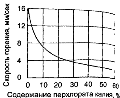
Рис. 6.3. Зависимость скорости горения смеси 40% ферросилиция + 60% хромата свинца от содержания в ней окислителя – ПХК [6].
