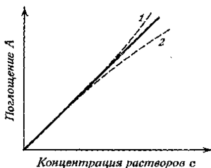
Р и с. 2. Кривые, иллюстрирующие отклонения от закона Бера. 1 — положительное отклонение; 2 — отрицательное отклонение.
