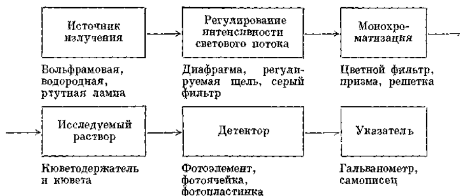
Рис. 4. Блок-схема спектрофотометра или фотоэлектроколориметра.
