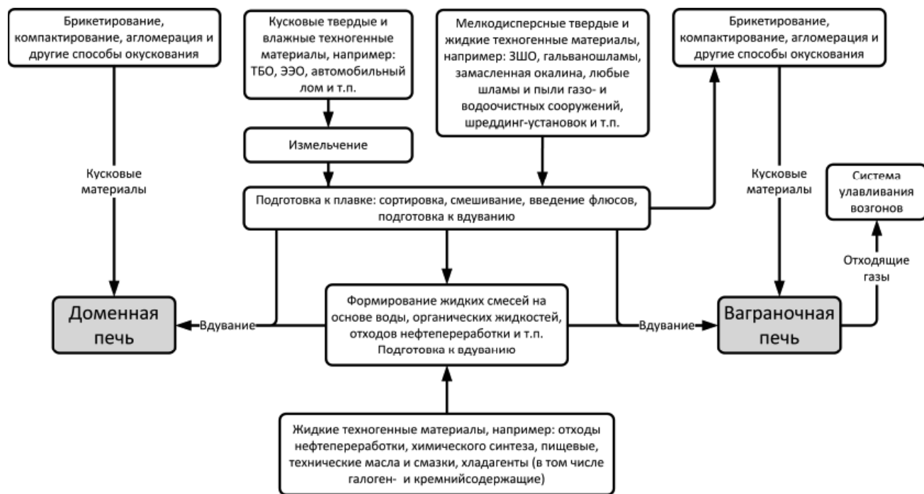
Рис. 6.2. Принципиальная схема применения техногенных материалов в шахтных печах
