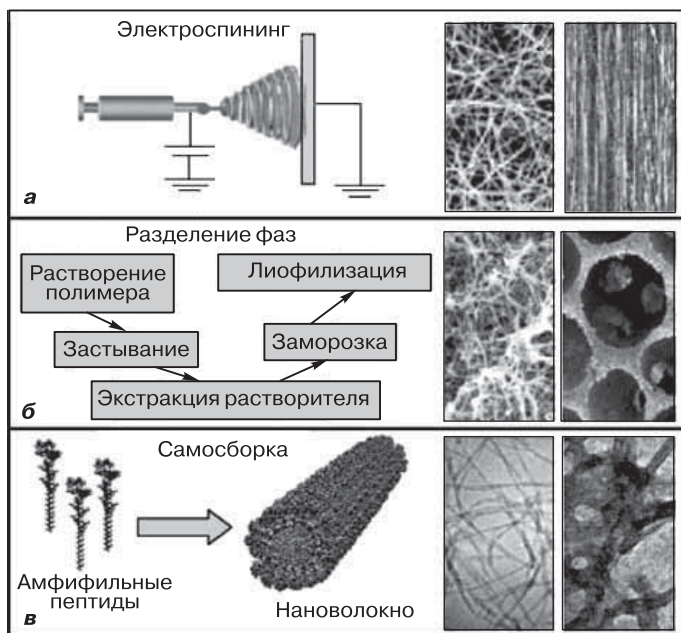
Рис. 15.3. Методология получения матриц на основе нановолокон в зоне контакта: а — типичная установка для проведения электроспиннинга и полученные матрицы с неупорядоченным и упорядоченным расположением нановолокон (воспроизводится в соответствии с [33] с разрешения Elsevier); б — стадии процесса разделения фаз, индуцированного изменением температуры, и полученные нановолокна и пены со сферическими порами (воспроизводится в соответствии с [19] с разрешения Elsevier); в — процесс самосборки молекул и полученные нановолокна и сформированная из них матрица (воспроизводится в соответствии с [49] с разрешения AAAS)
