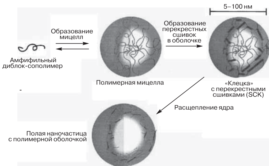
Рис. 4.5. Общая схема синтеза наночастиц со структурой «клетки» (SCK). Стадия деградации применяется для синтеза полых частиц. Воспроизводится в соответствии с работой [82] с разрешения авторов.
