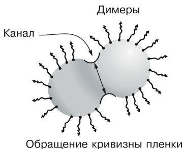
Рис. 8.8. Схема обращения кривизны пленки эмульсии при контакте двух капель [389]
