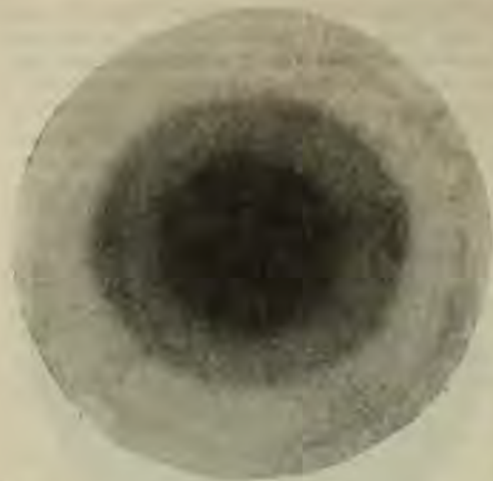
Рис. 152. Рентгенограмма пучка параллельных волокон рами, подвергнутых мерсеризации в течение продолжительного времени в 27% NaOH. Рентгенограмма показывает уменьшение параллельности кристаллитов в волокне (точки расплылись в круги). Направление волокна вертикальное. Собственный снимок.
