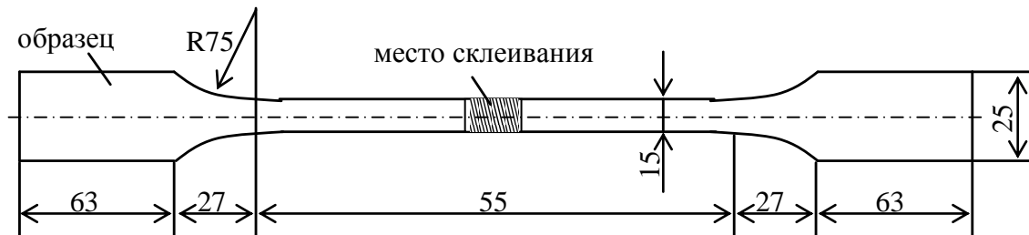
Рис.23. Образец для испытания клеевых соединений органических стекол на растяжение
