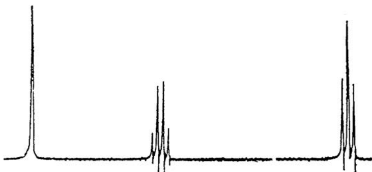
Рис. 2.5. Спектр ^1\text{H} -ЯМР этанола, записанный на спектрометре с рабочей частотой 60 МГц и высокой однородностью поля
