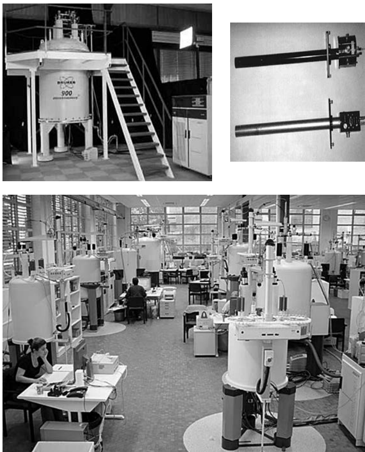
Рис. 2.18. Спектрометр AVANCE-900 фирмы «Брукер» с соленоидом на 21,06 Т и измерительные датчики к нему (вверху). Вид современной лаборатории ЯМР с несколькими спектрометрами в крупном научном центре (внизу)
