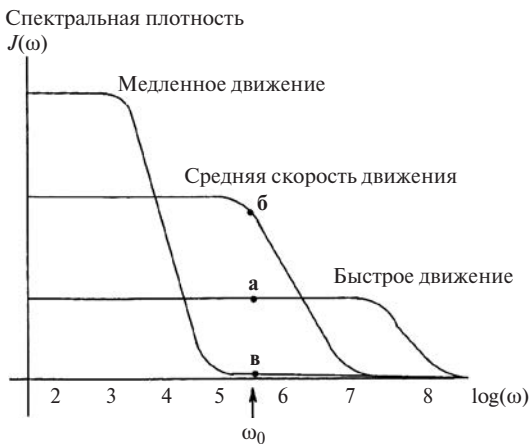
Рис. 2.11. Спектральная плотность J(\omega) как функция \tau_c для разных скоростей движения молекул
