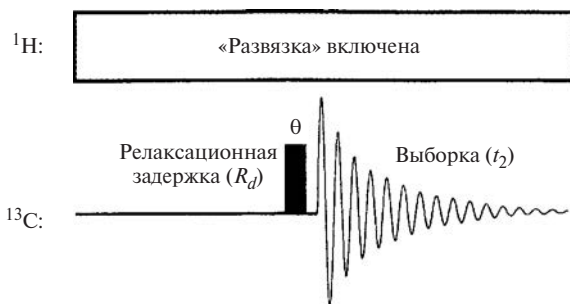
Рис. 6.1. Схема стандартного эксперимента ^{13}\text{C} — \{^1\text{H}\} -ЯМР с «широкополосной развязкой» от протонов
