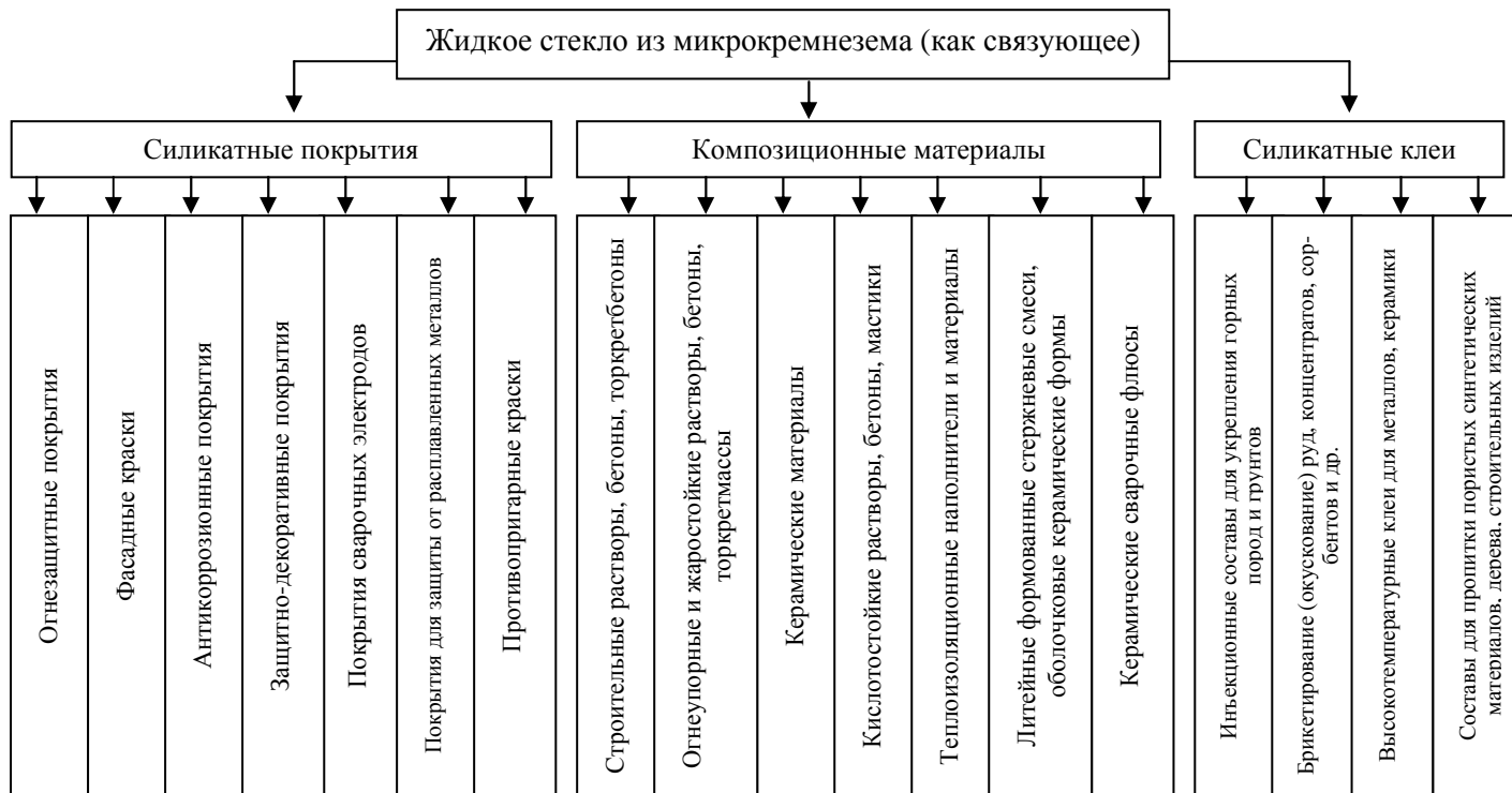
Рис. 9.11. Области применения жидкого стекла в качестве связующего
