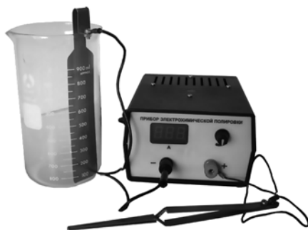
Рис. 13.7. Общий вид установки для электрохимического полирования
