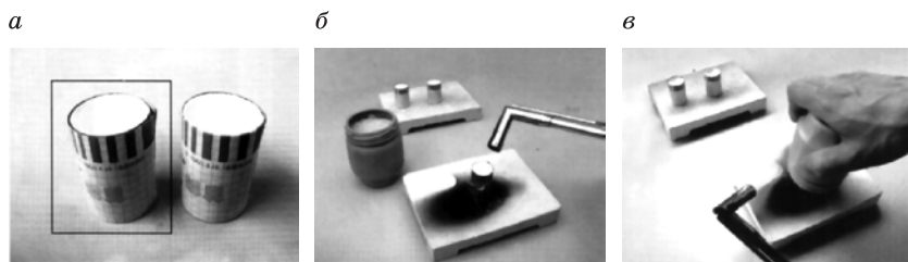
Рис. 5.27. Литье в одноразовые унифицированные формы
