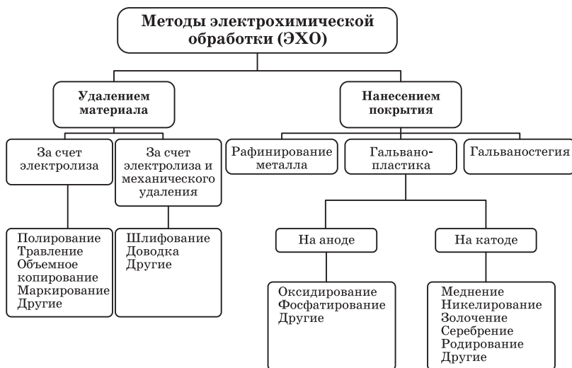
Рис. 13.4. Классификация методов электрохимической обработки
