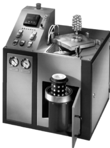
Рис. 5.24. Литьевая вакуумная машина модели Vetter Technik IC 10
