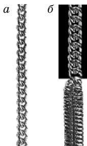
Рис. 10.24. Цепочка до (а) и после (б) уплотнения
