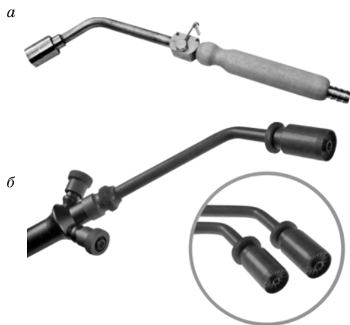
Рис. 8.1. Газопламенные горелки: а — бензиновая; б — газовая
