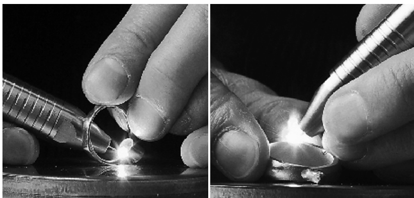
Рис. 8.7. Примеры выполнения работ при контактной сварке
