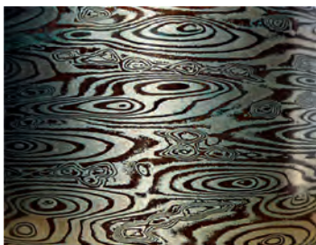
Рис. 12.5. Изделия, полученные технологией макуме-гане
