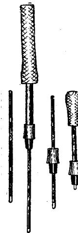
Рис. 13. Откачивание и запаивание капилляров.
