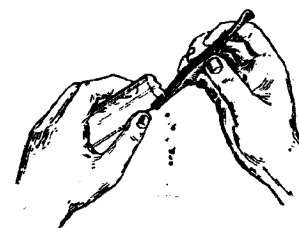
Рис. 103. Выравнивание края стеклянной трубки пинцетом.
