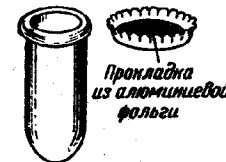
Рис. 71. Реакционный сосуд для проведения реакций под давлением с малым количеством реагентов.
