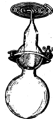
Рис. 70. Видоизмененная колба Гроссе для проведения реакций под давлением.
