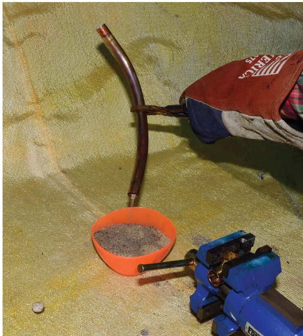
FIGURE 5-16: Pour out the hot sand.
