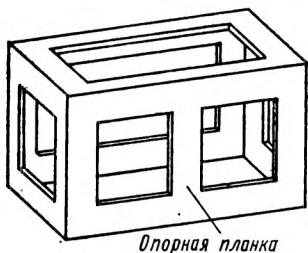
Рис. 1. Деревянный каркас для сварки футеровки из листового свинца или пластиката
