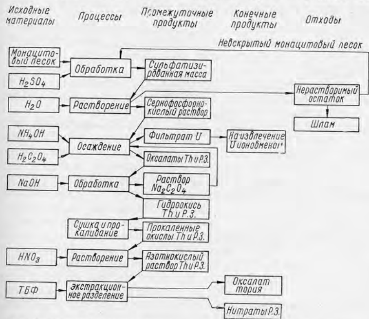
Рис. 9. Технологическая сернокислотная схема переработки монацитового концентрата с последующим выделением оксалатов тория и редких земель из сернофосфорнокислого раствора.
