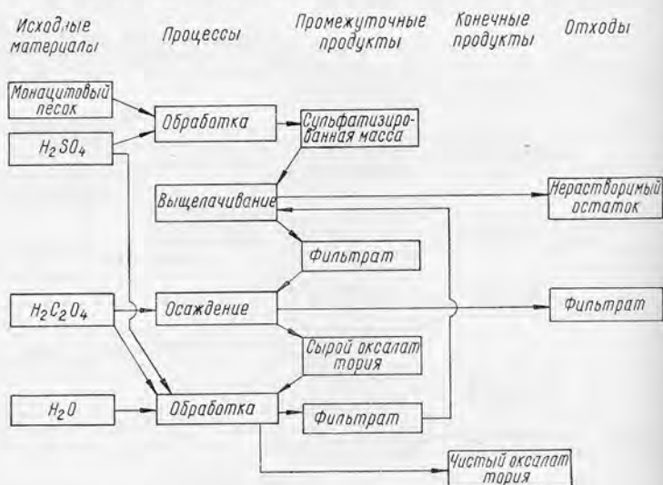
Рис. 10. Технологическая серноокислотная схема переработки монацитового концентрата с последующим селективным осаждением оксалата тория в сернофосфорнокислом растворе.
