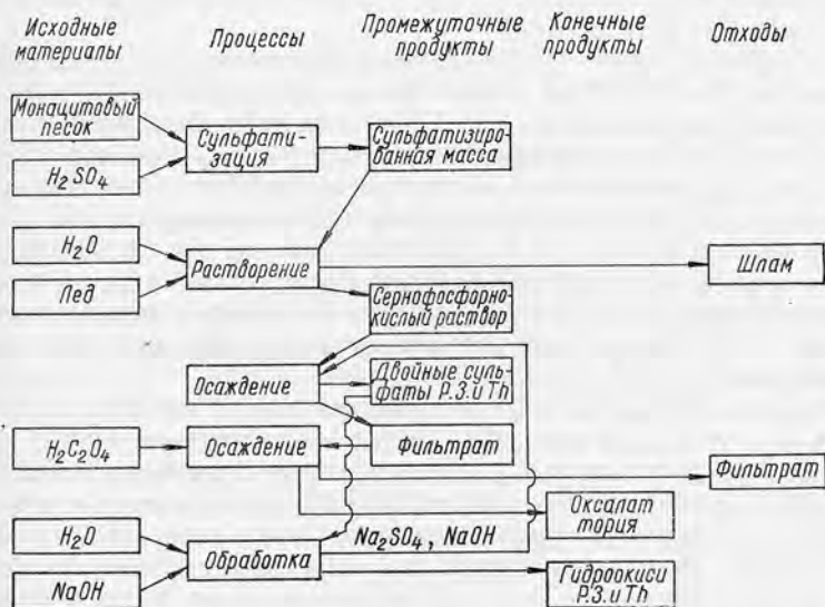
Рис. 6. Технологическая сернокислотная схема переработки монацитового концентрата с последующим разделением тория и редких земель осаждением двойных сульфатов.
