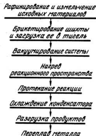
Рис. 49. Принципиальная схема получения металлов методом вакуумной металлотермии
