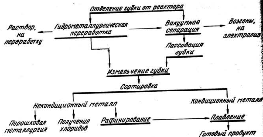
Рис. 37. Схема переработки металлотермической губки
