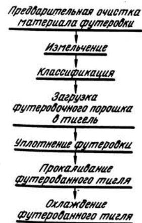
Рис. 8. Схема футерования тигля
