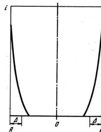
Рис. 17. Изменение плотности тока ( i ) по сечению загрузки при индукционном нагреве
