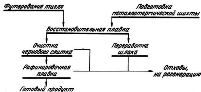
Рис. 7. Общая схема получения слитков металлов металлургическим способом
