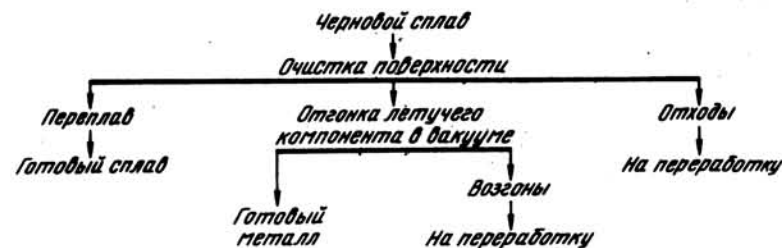
Рис. 31. Схема переработки чернового слитка сплава
