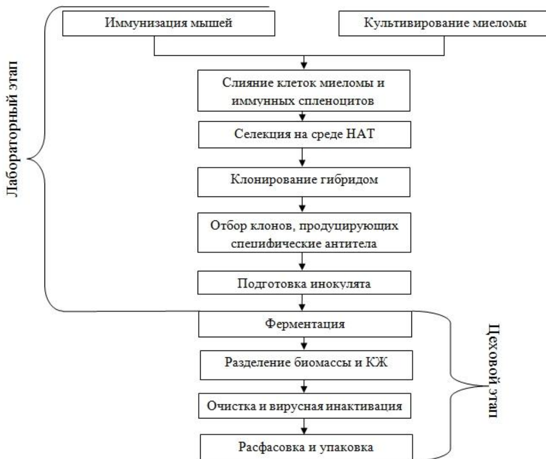
Рис. 1 – Технологическая схема производства моноклональных антител
