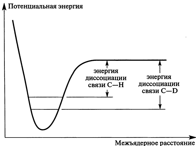
Рис. 6.4. Диаграмма энергии молекулы. Связь C—D имеет более низкую энергию нулевых колебаний и соответственно более высокую энергию диссоциации, чем связь C—H
