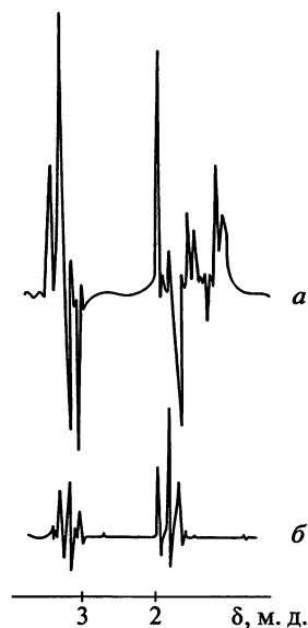
Рис. 5.1. Спектр ЯМР, снятый в процессе реакции между EtI и EtLi в бензоле (а). Область между 2,5 и 3,5 м. д. сканирована с двойной амплитудой. Сигналы при 1,0 и 1,6 м. д. относятся к бутану, некоторое количество которого также образуется в ходе реакции. Эталонный спектр EtI (б). Печатается с разрешения из Ward, H. R.; Lawler, R. G.; Cooper, R. A. J. Am. Chem. Soc. 1969, 91, 746. Copyright © 1969, American Chemical Society
