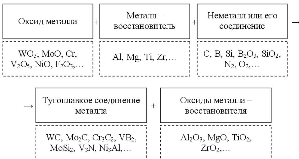
Рис. 2.30. Схема жидкофазного СВС.
