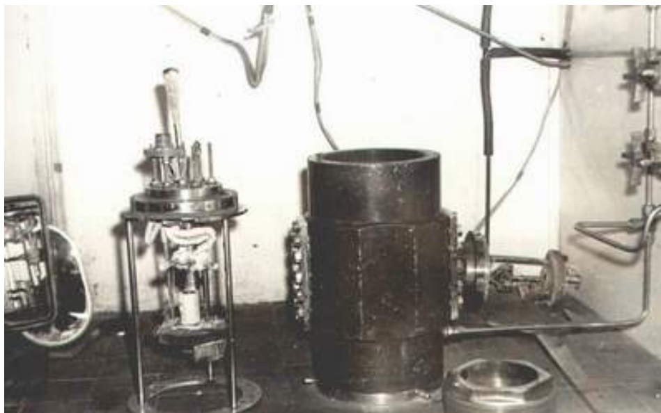
Рис. 3.18. Внешний вид реактора СВС – Аз-4,5 в разобранном виде
