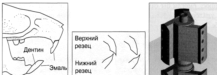
Рис. 4.4. Резцы и дробилка. Слева: резцы крысы. В центре: стачивающее движение верхней и нижней челюсти постоянно заостряет резцы. Справа: самозатачивающаяся дробилка, вдохновленная этим методом. (© Marcus Rechberger, Fraunhofer Institute for Environmental, Safety & Energy Technology)
