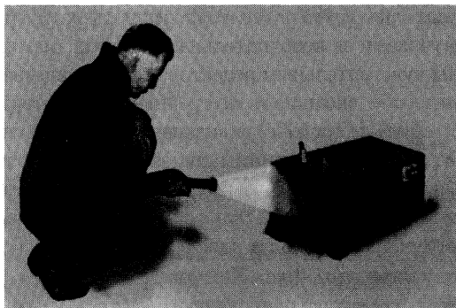
Рис. 5.5. «Электромеханическая собака» Хаммонда ( Hammond ) и Мьеснера ( Miessner ) привлекается светом фонарика. (© Roberto Cordeshi, Università di Roma, La Sapienza )
