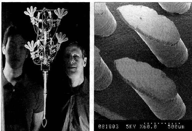
Рис. 6.5. Робот геккон и его нановорсинки. Слева: Stickybot — четвероногий робот-геккон, умеющий карабкаться по стеклу, и наблюдающие за ним разработчики. Справа: наноструктура искусственных микроворсинок со сплюснутыми концами. (© Mark R. Cutkosky, Центр дизайнерских исследований Стенфордского университета.) (См. цветную вклейку)
