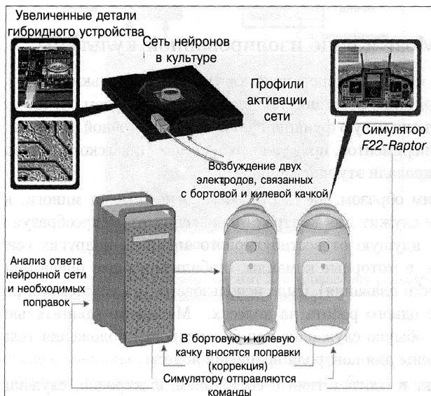
Рис. 12.4. Система контроля симулята F22 Raptor с помощью нейронов в отдельной культуре. (© Thomas DeMarse, University of Florida)
