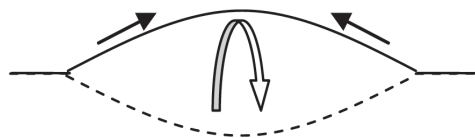
Рис. 5.4. Макромолекула-«скакалка». Стрелки показывают характер предполагаемого вращения макромолекулы и направления действия результирующей «стягивающей» силы
