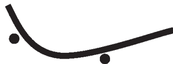
Схематическое изображение характера деформации, испытываемой волокном в войлоках и других нетканых материалах
