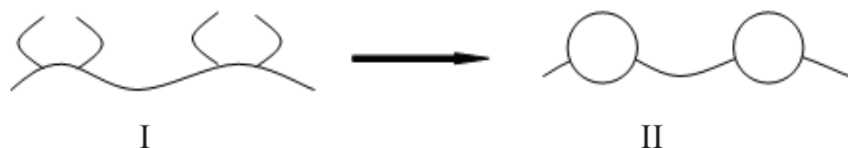
Рис. 8.9. Схематическое изображение форполимера I и его превращение через замыкание циклов в полигетероарилен II
